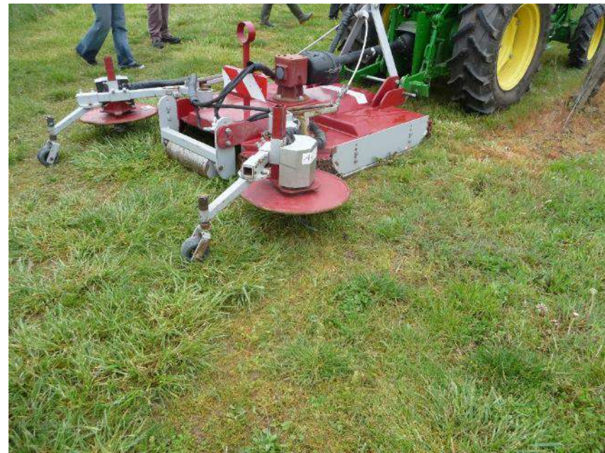
Tondeuse combinée inter-rang et satellites intercepts AVIF 33
