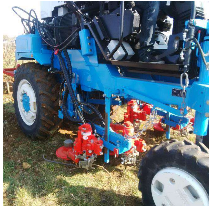
Intercepts hydrauliques Boisselet sur tracteur enjambeur Bobard
